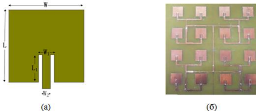
Рисунок 1. (а) Геометрия элемента. W=28 мм, L=29 мм, W_1=5.8 мм, W_2=3 мм, L_1=11 мм (б) фотография созданной сфокусированной антенной решетки.
