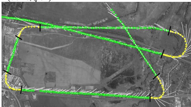
Рисунок 5. Траектория, участвующая в экспериментах. Положения БПЛА на кадрах с движением по прямой отмечены зелеными точками, с поворотом – желтыми. Черными отрезками отмечены границы между участками. Белыми отрезками соединены координаты БПЛА и соответствующие им центры фотографирования.
