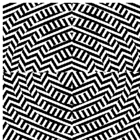
Рис. 1. Схема штрихов пропускающей бинарной металлинзы, одновременно преобразующей линейную поляризацию в радиальную и фокусирующей свет.
