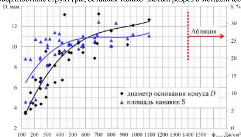
Рисунок 7. Корреляция между относительной площадью канавки S , диаметром основания конуса D и накопленной плотностью лазерной энергии \phi_{\text{Acc}} .
