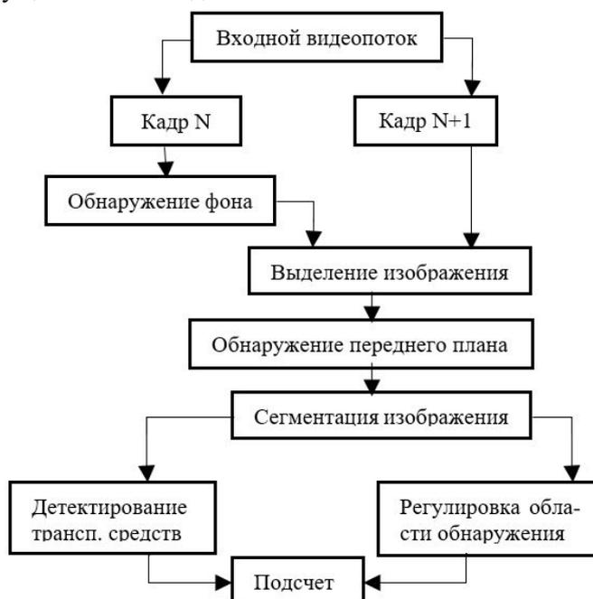
**Рисунок 2.** Схема алгоритма.
