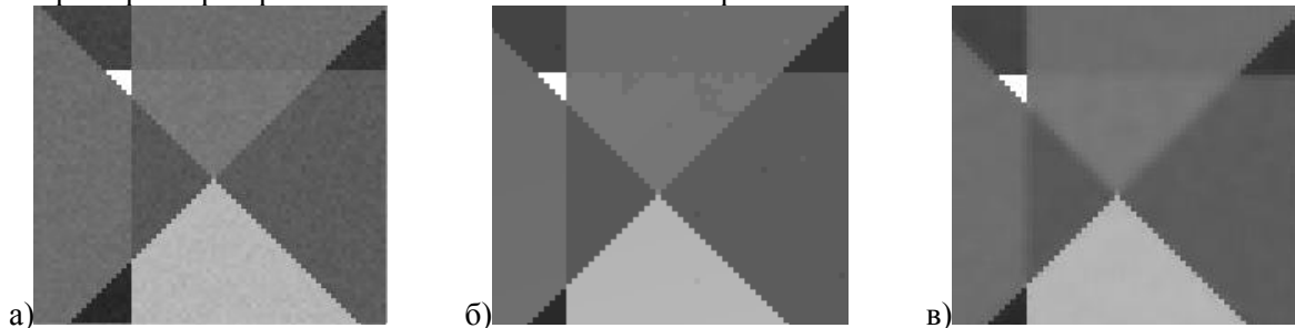
Рисунок 4. Восстановление зашумлённого кусочно-постоянного изображения: а) фрагмент зашумлённого изображения ( \rho = 0,95 ; d = 200 ; \varepsilon = 10 ), б) фрагмент изображения после восстановления при помощи суперпиксельной фильтрации, в) фрагмент изображения после восстановления при помощи винеровской фильтрации.
