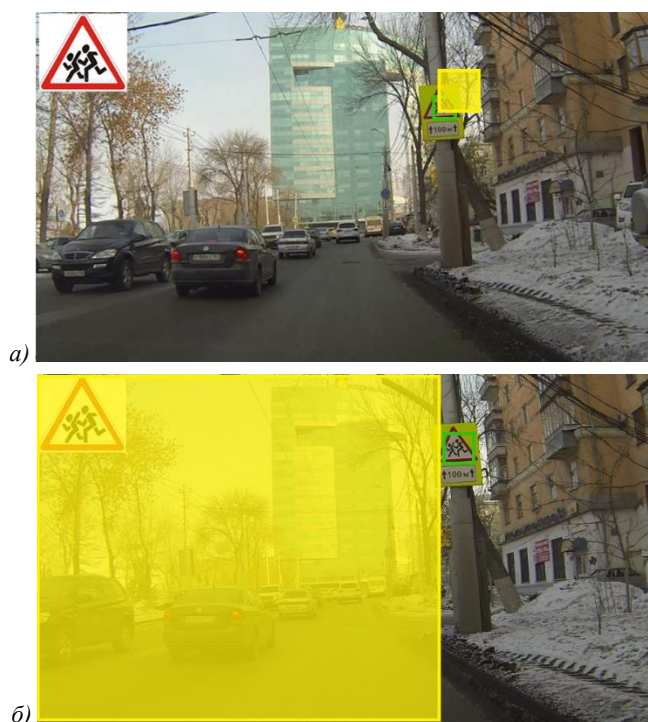
Рис. 6. а) Изображение с отмеченной областью поиска дорожного знака на следующем кадре; б) Следующий кадр с отмеченной областью поиска других не отслеживаемых дорожных знаков.
