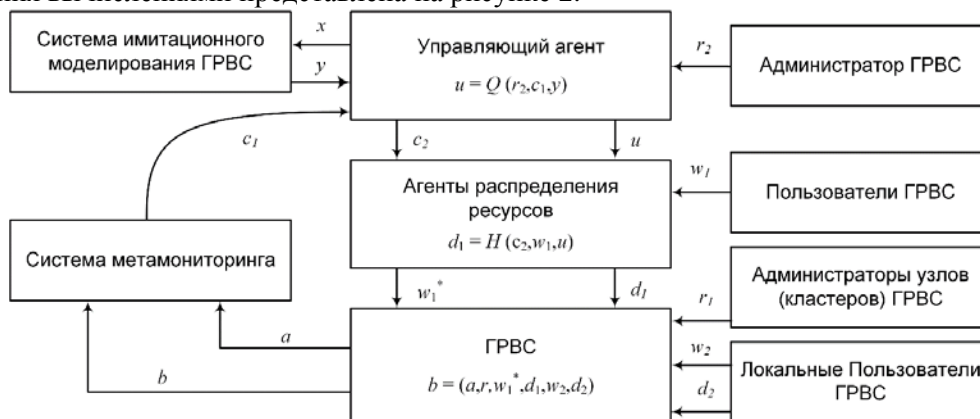
Рисунок 2. Структурная схема системы управления вычислениями.
