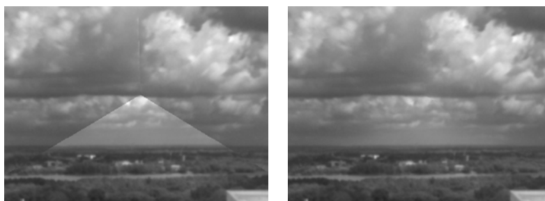
Рисунок 3. Иллюстрация к процедуре блендинга (условия наблюдения – облачность, 3х оптический зум): слева – исходный кадр в ОИ, справа – после блендинга.
