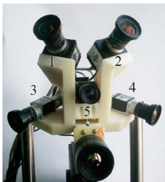
Рисунок 1. Камеры макета РПС: LWIR (снизу по центру) и пять ТВ.
