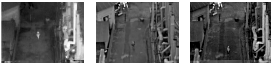
Рисунок 5. Результаты работы алгоритма комплексирования [24] (условия наблюдения – мелкий дождь, сумерки): слева – ИК кадр, по центру – ТВ кадр, справа – кадр в режиме комплексирования.
