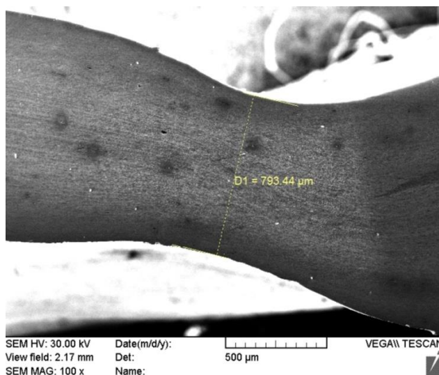
Рис. 2. Утонение в зоне термического влияния.
