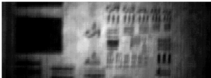
Рис. 3. Изображение мирры сформированное изображающим гиперспектрометром на длине волны 550нм.
