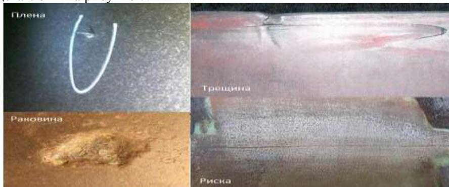
**Рисунок 7.** Пример поверхностных дефектов металлических труб.
