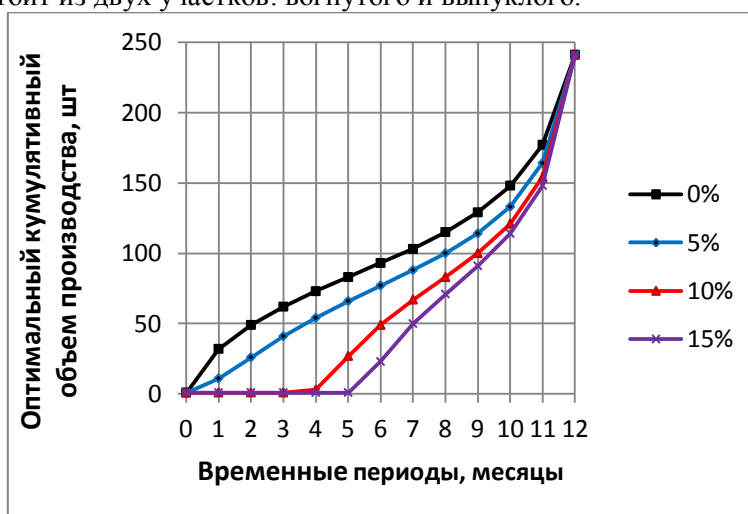
Рисунок 3. Зависимость оптимального кумулятивного объема производства от ставки дисконтирования для логистической модели трудоемкости.
