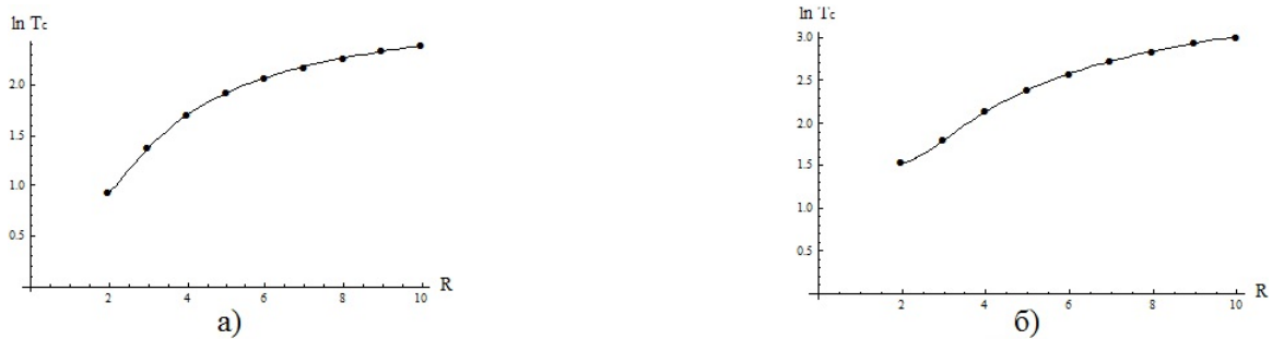
Рис. 6: Зависимость критической температуры от R_k для двумерной (а) и трехмерной (б) моделей Изинга
