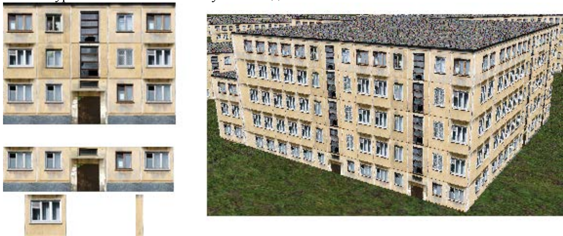
Рисунок 5. Стандартная текстура для стены здания, разделение текстуры на участки: подъезд, окно и стена и полученная 3D модель.
