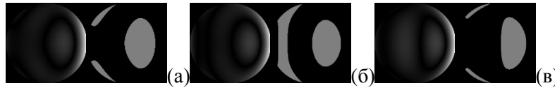
Рисунок 7. Амплитуда и фаза: восстановленный волновой фронт по абсолютным значениям коэффициентов Цернике в плоскости z_1=200 (а), z_2=1100 (б), (в) – Фурье плоскость (ФРТ).
