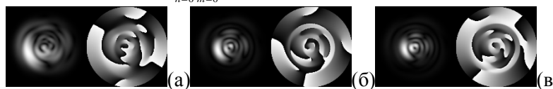
Рисунок 6. Амплитуда и фаза: восстановленный волновой фронт по комплексным коэффициентам Гаусса-Лагерра в плоскости z_1=200 (а), z_2=1100 (б), (в) – Фурье плоскость.
