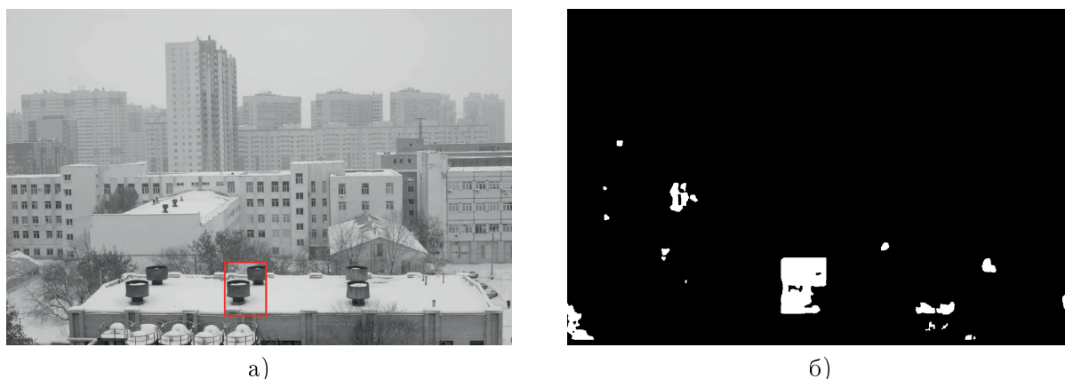
Рисунок 6. Пример обнаружения дублированного фрагмента: а) исходное искаженное изображение, б) бинарная маска, полученная в результате применения алгоритма обнаружения.
