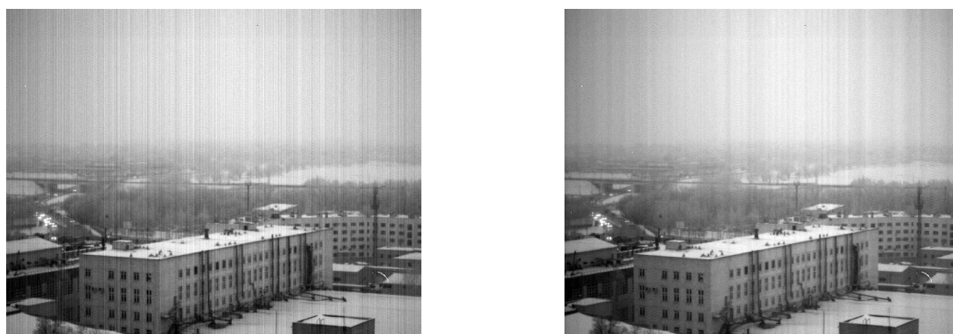
Рисунок 1. Кадры с видеокамеры Xenics Bobcat 640 в режиме с выключенной компенсацией ГШ и битых пикселей: слева – исходное изображение, справа – после компенсации ГШ по [17].
