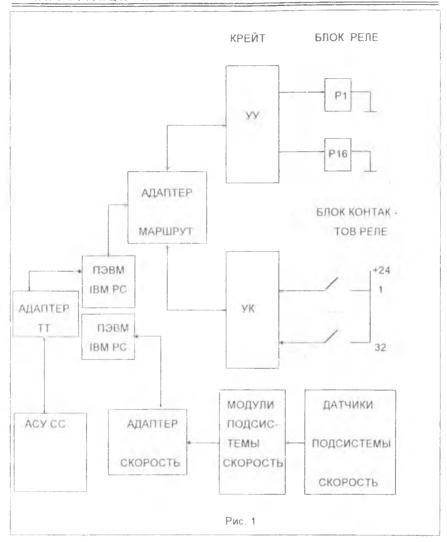
Основным режимом работы ПО АСМ является автоматический роспуск состава, обеспечивающий включение маршрутных реле под каждый поступающий отцеп в соответствии с информацией из сортировочного листа и контроль прохождения отцепов по разделительным стрелкам с целью выявления "чужаков".
