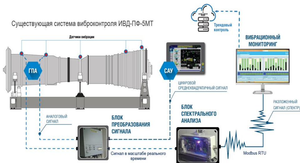
Рис. 1. Структурная схема системы удаленного вибромониторинга
