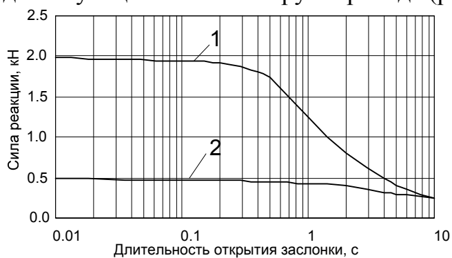
Рисунок 4 - Зависимость максимальной силы реакции потока жидкости во втором изгибе трубопровода от длительности открытия ЭПЗ при первоначально воздушном (1) и жидкостном (2) заполнении трубопроводной магистрали, давление в емкости 0,6 МПа, объем воздушной подушки - 0,3 м 3
