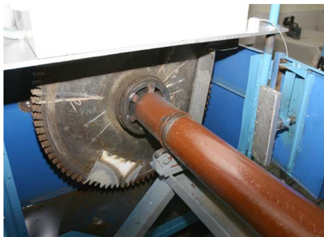
Рис. 17. Фото монтажного места вала с диском турбины при ТПУ
