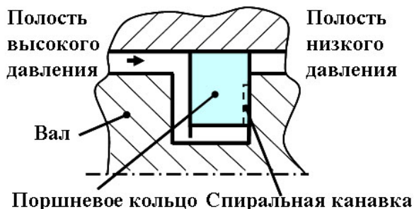
Рис. 13. Схема уплотнения подвода масла внутри вала
