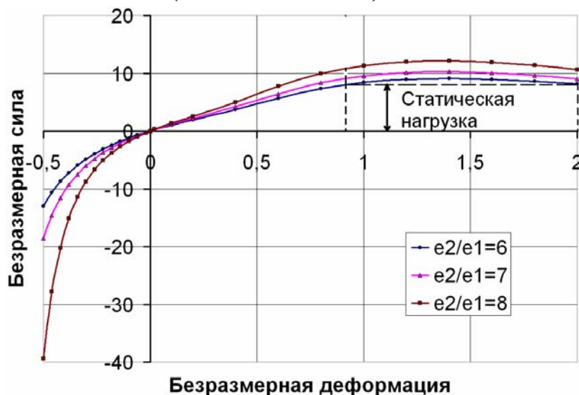
Рис. 4. График функции \beta = f(e_2/e_1, \zeta_y) с областью, где жесткость близка к квазиулевой
