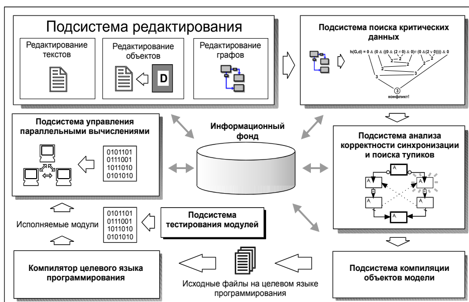
Рис. 3 – Структура программного комплекса PGRAPH 1.0
