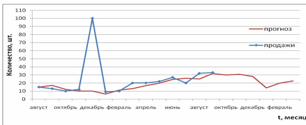
Рис. 2 - Расчет прогноза методом экспоненциального сглаживания с учетом сезонности и доверительного интервала для «AR41N-PD»
