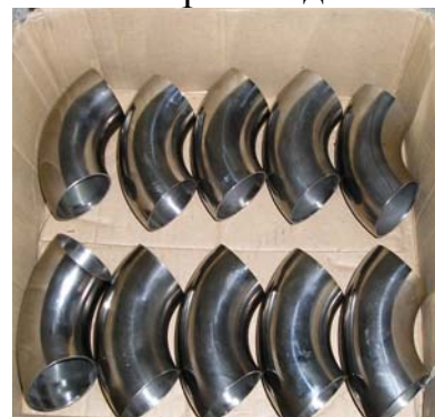
Промышленная партия тонкостенных крутоизогнутых отводов из стали 12X18H10T
