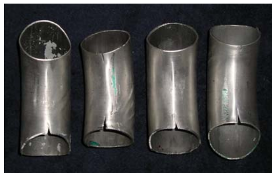
Рисунок 4 – Разрушение торцев при формообразовании.
