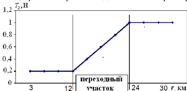
Рисунок 6 – Схема изменения величины управляющего натяжения T_2 от длины выпущенного троса r при наличии переходного участка
