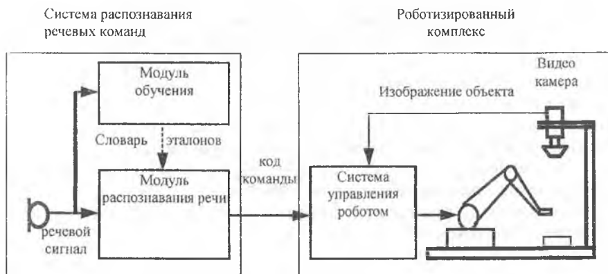
Рис. 1. Функциональная схема системы управления роботом по аудио информации
