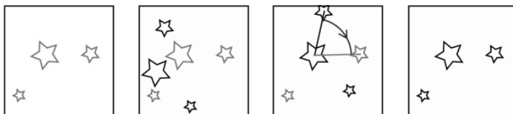
Рисунок 2 – пример алгоритма выбора по двум ярчайшим звездам
