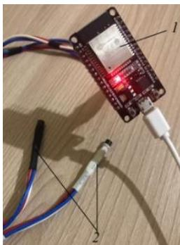
1 – микроконтроллер, 2 – термодатчики.
