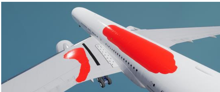
Рисунок 1 – Выделение на самолете необходимых для покраски областей
