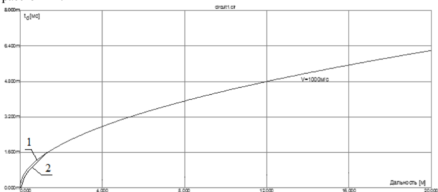
Рисунок 1 – Графики зависимости задержки времени приема отраженного сигнала от дальности, где 1 график – упрощенная формула, 2 график – без упрощения.
