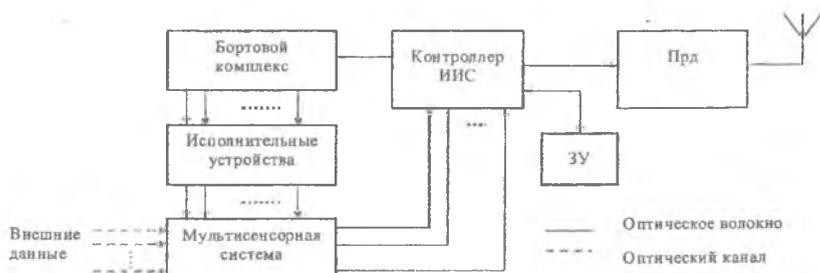
Рис.5. Интегрированная телеметрическая система АМП
