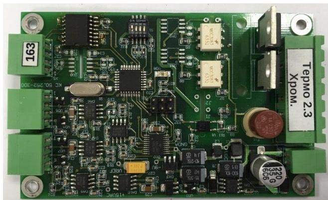
Рисунок 1 – Двухканальный терморегулятор
