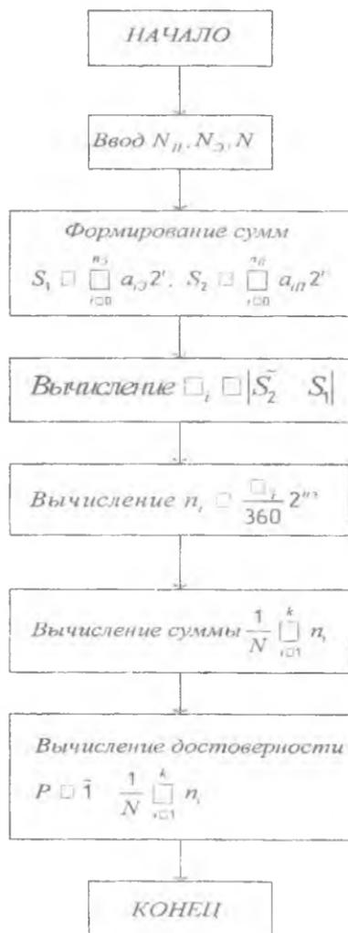
Рис.4. Блок-схема алгоритма расчета достоверности ЦПУ в ПК
