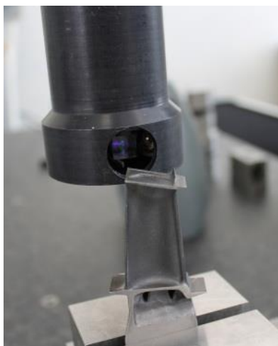
Рисунок 1 – Лазерная головка КИМ в системе контроля профиля лопатки ГТД
