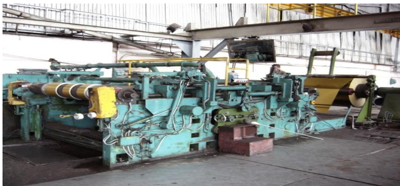
Рисунок 1 - Линия продольной резки алюминиевого проката
