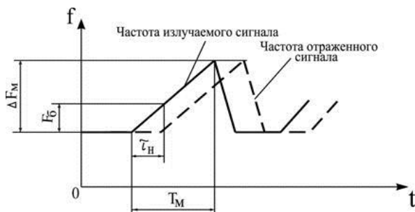
Рисунок 1 – К описанию работы радиовысотомера
