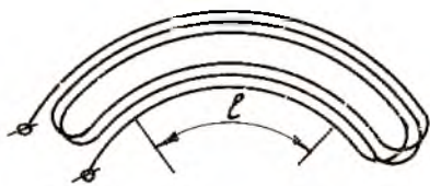
Р и с. 3. Схема конструкции компенсирующей катушки
