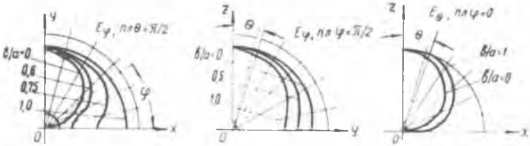
Рис. 5. Характер изменения диаграмм направленности при различных значениях эллиптичности кольца.
